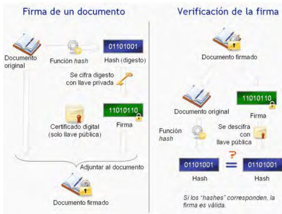
Representação sobre o mecanismo de assinatura. Fonte: Suporte da assinatura
